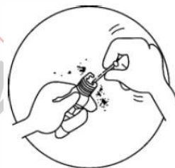
3. Curățați orice urmă de carbon sedimente.
