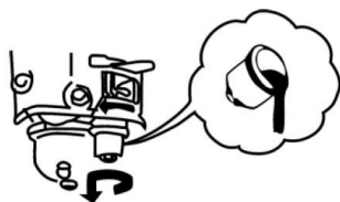
1. Girare il rubinetto del carburante in posizione "OFF", rimuovere la coppa del filtro del carburante e scaricare il carburante presente nella coppa. (Modello: unità semplice)
