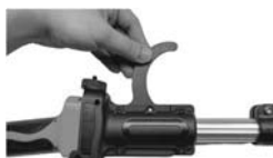
10. Вкарайте куката в празния отвор в главата на шината, като куката трябва да сочи надолу.
