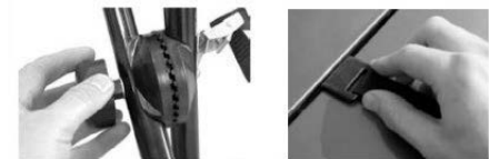
Ξεβίδωμα ενός από τους μηχανισμούς ασφάλισης
