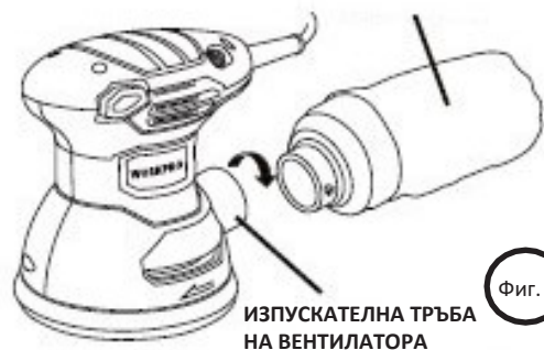
МОНТАЖ НА ТОРБИЧКА ЗА ПРАХ
