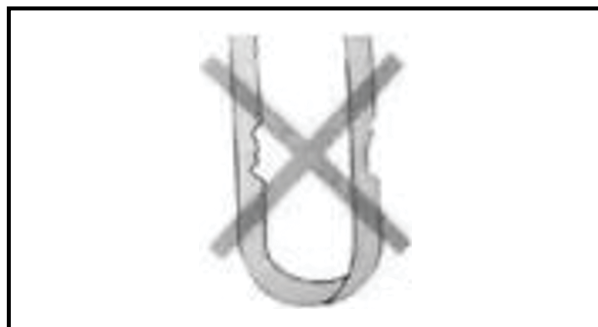
Nie używaj uszkodzonych zawiesi.
