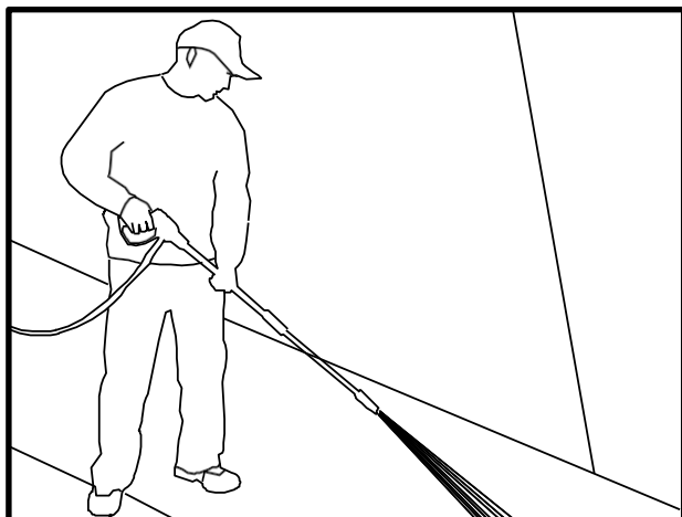
Слика 6 - Оптимални угао за чишћење површина
