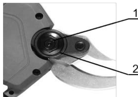
1. Hatlapú csavar, 2. Pengék meghúzóanyája
